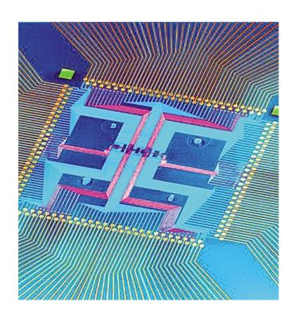
由数百个纳米线自组装而成的 nanoFSM 只占据芯片中心很小的区域,却拥有现有集成电路中金属线相同的功能。
